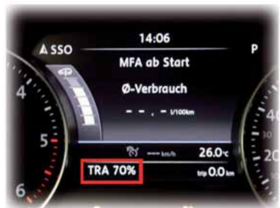
Touareg Modelljahr 2011 mit eingeschaltetem Transportmodus und Batterieladezustand 70 %
