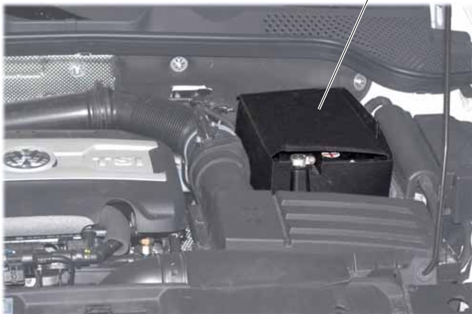
Batterie im Motorraum mit Batteriewärmeschutz
